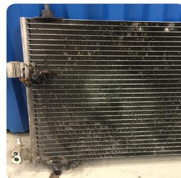
Scheinen eng, doch ein Kondensator in einem solchen Zustand kann nicht gut funktionieren und muss auf jeden Fall ausgetauscht werden
