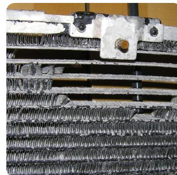
Mehrere Reihen durch Korrosion des Kondensators fehlende Rippen
