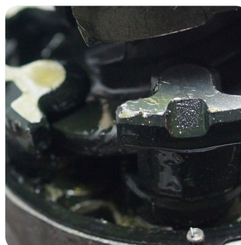
Krystalliseret lækagestopmiddel har fortykket olien og dannet synlige klumper på slingreplade og stempler
